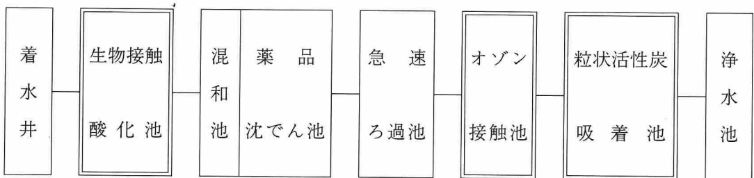
北谷浄水場浄水処理フロー図
