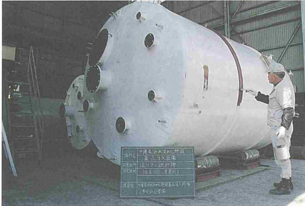
薬品貯蔵槽の工場製作
