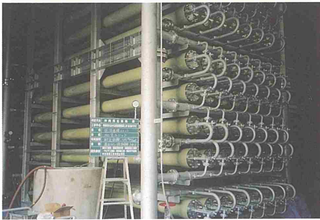
ROユニット耐圧試験 (試験圧 105kg/cm 2 )
