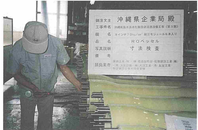
FRP ベッセルの工場検査 (寸法検査)
