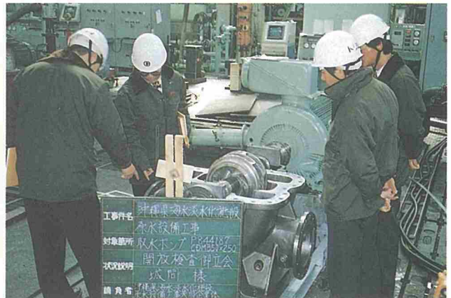
取水ポンプの工場立会検査（性能検査、開放検査）
