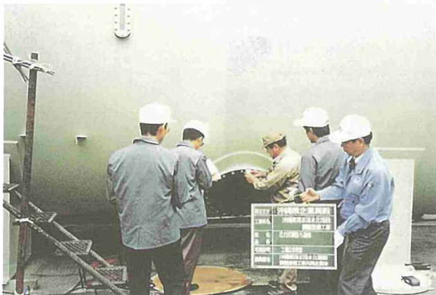
ろ過機の工場立会い検査（外観検査）
