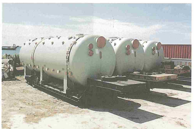
低床トレーラーにてろ過機の搬入
