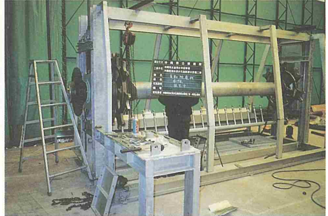
自動除塵機の工場製作
