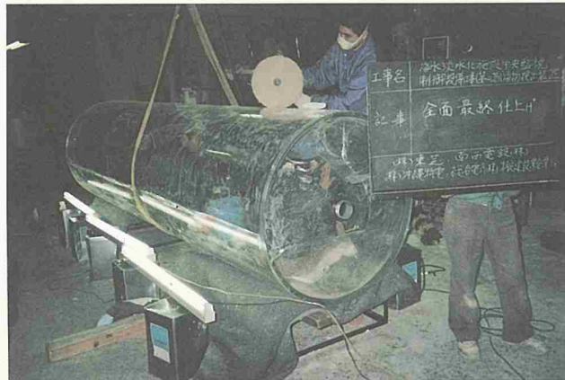
毒物検出装置工場製作状況
