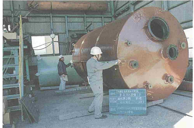
薬品貯蔵槽の工場検査（寸法検査）
