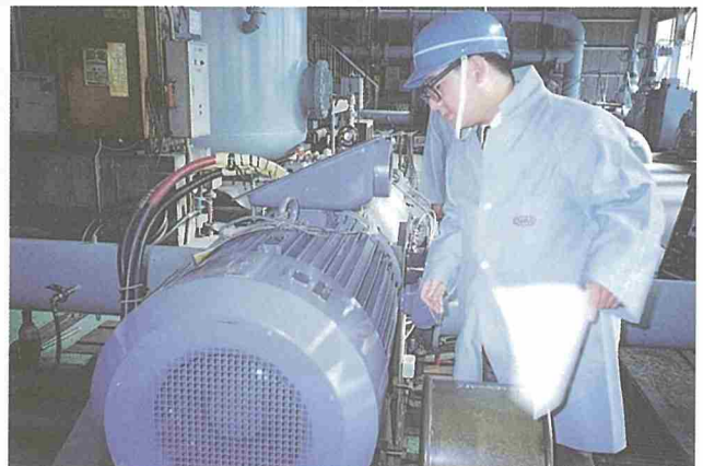
洗浄ポンプの工場立会い検査（性能検査）
