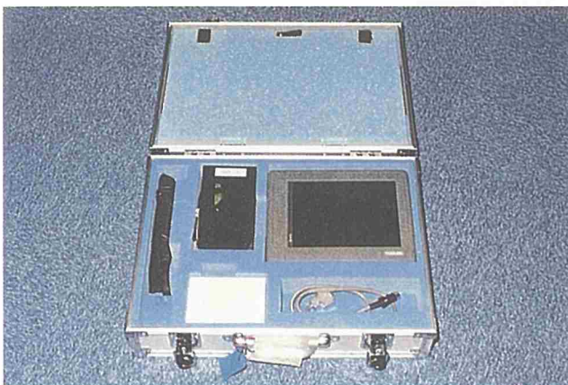
携帯用現場操作盤収納状況
