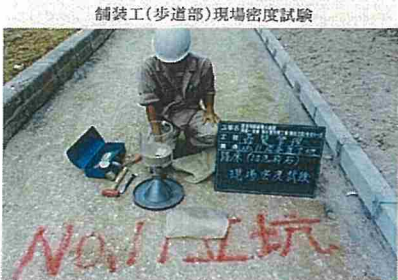
舗装工(歩道部)現場密度試験
