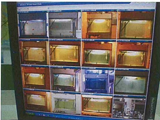
各取水ポンプ場の魚水槽のモニタリング
