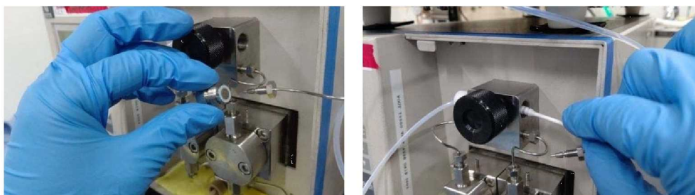
Fig.23_ラインフィルター取り外しと清掃
