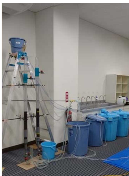
Fig.2_Mn砂ろ過装置
