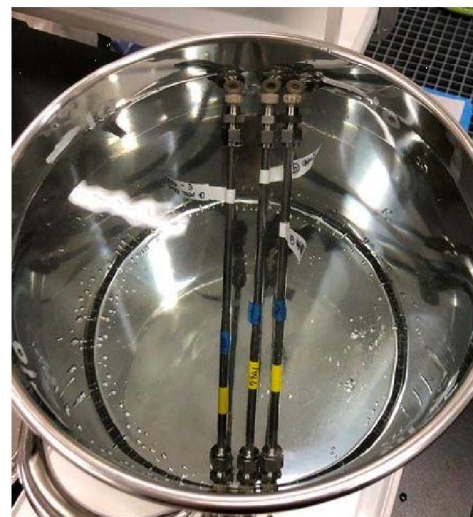
Fig.30_カラムおよびポンプの封印
