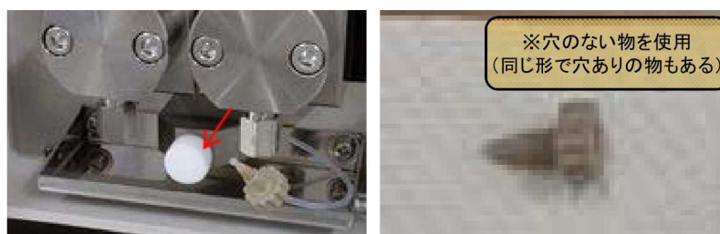
Fig.28_カラムおよびポンプの封印
