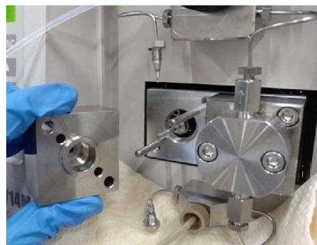
Fig.24_洗浄ヘッド取り外し
