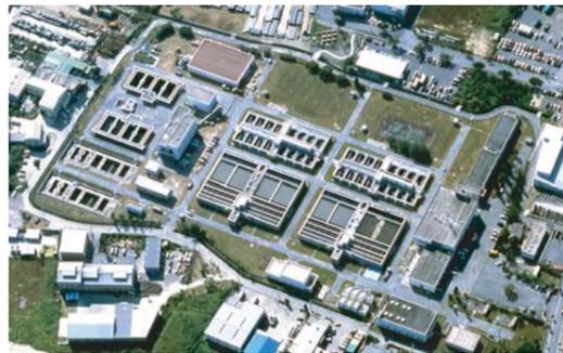
西原浄水場は、本島中部の西原町にあり、昭和52年6月に一部供用を開始し(4万100m<sup>3</sup>/日)その後の4期にわたる工事を経て、昭和55年3月に現在の1日当たり16万500m<sup>3</sup>の処理能力を有する浄水場となっています。
