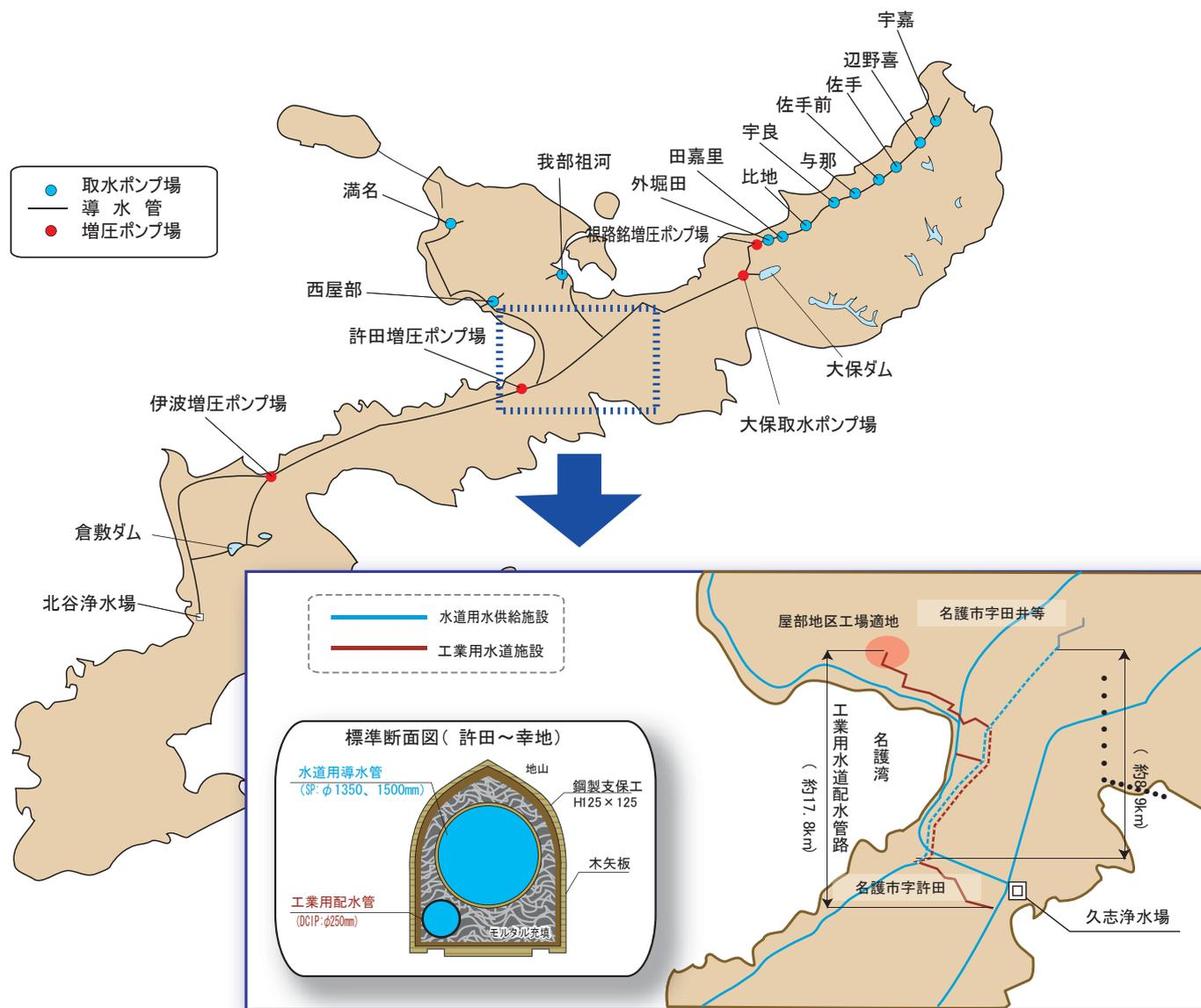
許田～幸地間のトンネル部分については、工業用配水管と水道用導水管の共同施工を行っています。
