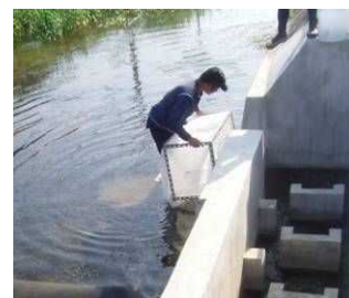
取水河川魚道 モニタリング調査
