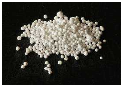
硬度低減化により除去されたカルシウム等の硬度成分 (生成ペレット)
