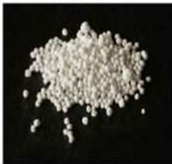
硬度低減化施設により除去された カルシウム等の硬度成分（生成ペレット）
